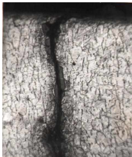
Рис. 10. Вид дефекта ( а , б ) на микрошлифе, x100
