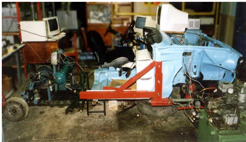
Рис. 7. Имитационный стенд-тренажер для испытания автоматизированных тормозных систем автомобилей
