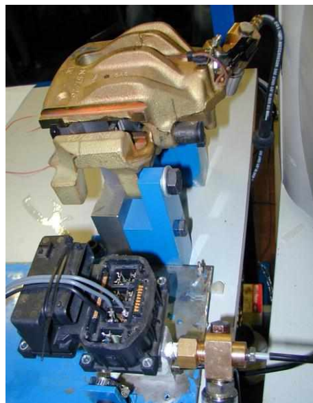
Рис. 5. Вид монтажа тормозного механизма и клапанов гидравлического блока Bosch ABS 5.3
