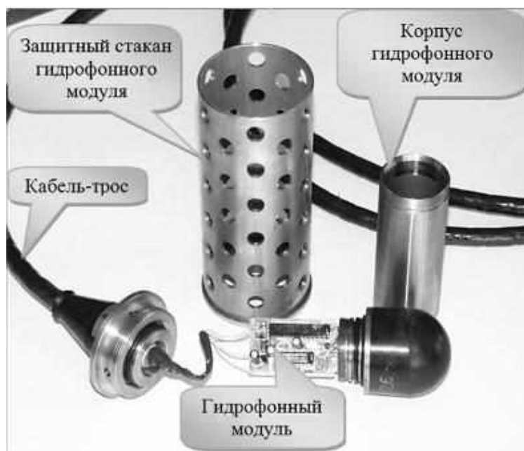
Рис. 3. Конструкция цифровой приёмной антенны
