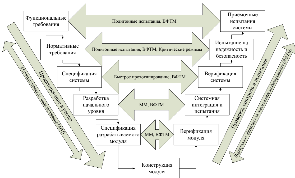
Рис. 2. V-цикл проектирования системы активной безопасности
