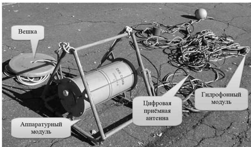
Рис. 1. Автономная морская сейсмоакустическая станция
