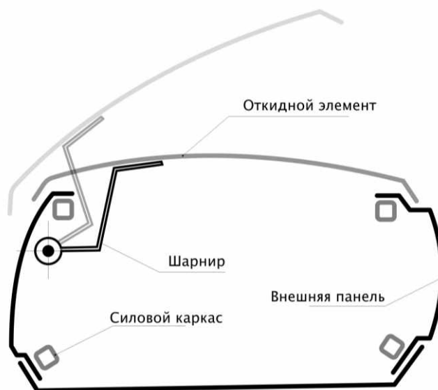
Рис. 1. Принципиальная схема каркасно-панельной конструкции
