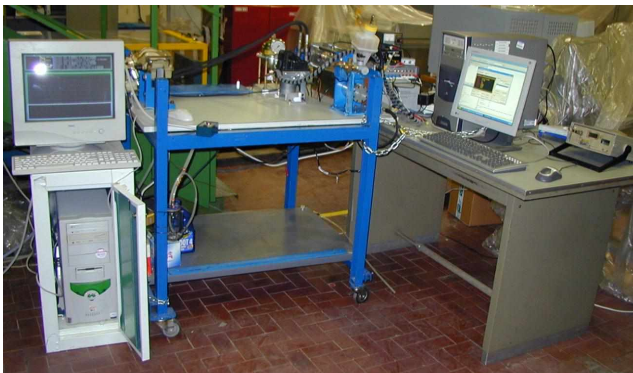
Рис. 3. Внешний вид стенда для испытаний электрогидравлических тормозных систем (
