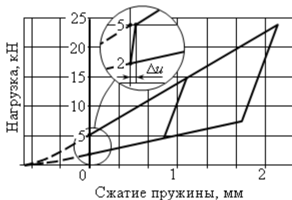
Рис. 3. Характеристика предварительно поджатой фрикционной кольцевой пружины
