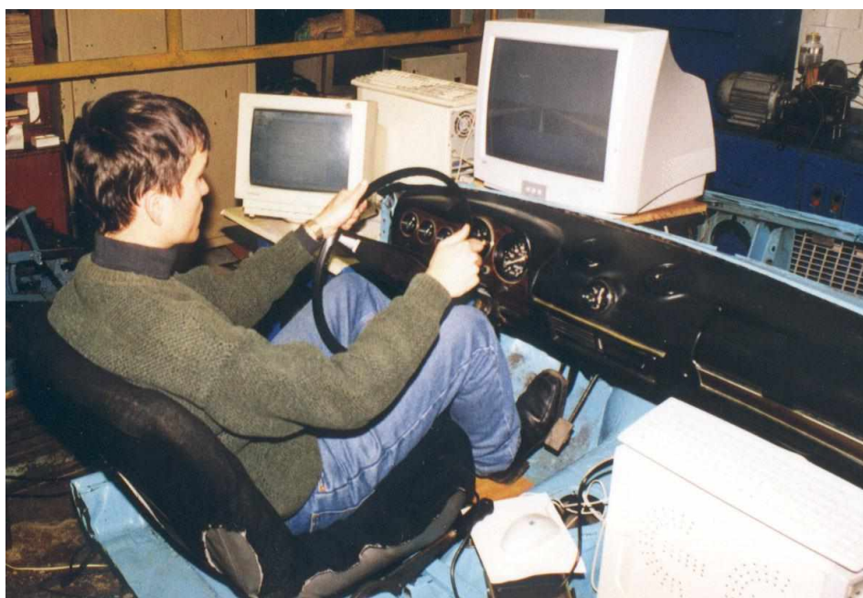
Рис. 8. Имитационный стенд-тренажер в ходе испытания автоматизированных тормозных систем
