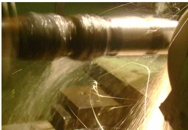
Рис. 4. Шлифование наплавленного металла на шейку вала абразивом при V=25 м/с
