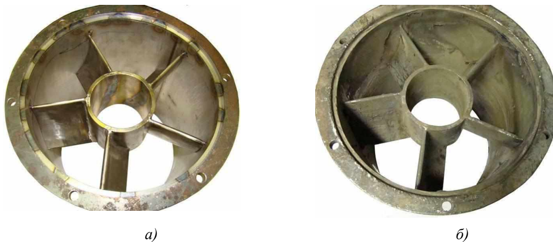
Рис. 4. Спрямляющий аппарат а – до испытаний; б – после испытаний на свинце после третьего этапа
