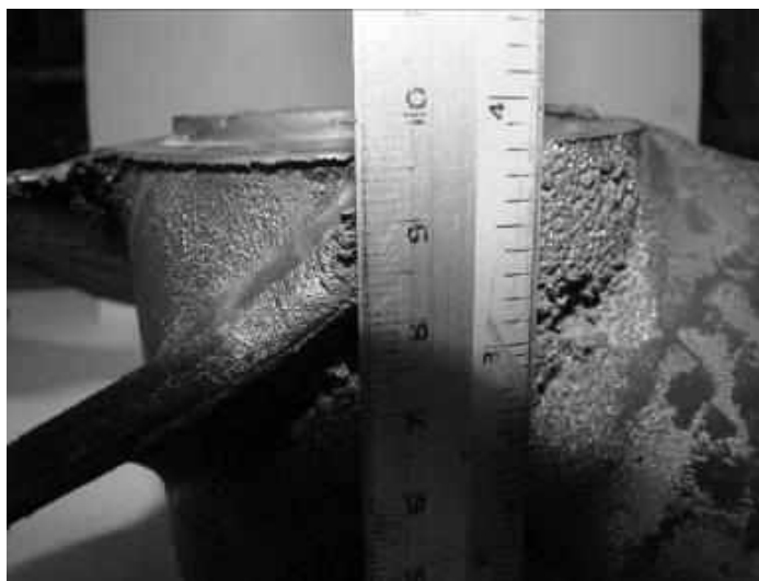
Рис. 9. Разрушение ступицы колеса
