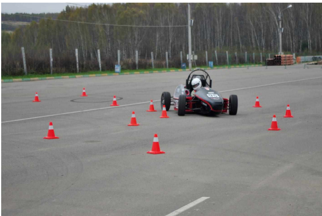
Рис. 5. Натурное испытание «движение по траектории постоянной кривизны»
