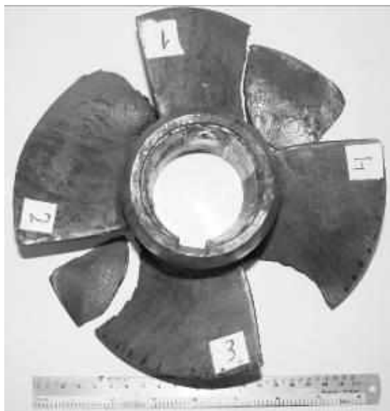
Рис. 8. Разрушение лопаток колеса
