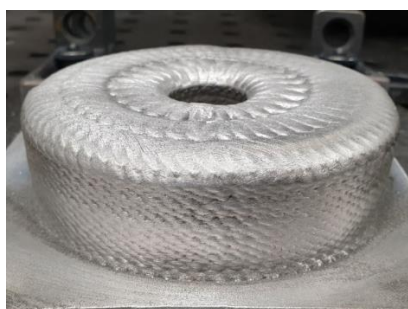
Рис. 14. Выращенный фланец: а — выращивание большого цилиндра; b — выращивание малого цилиндра.
