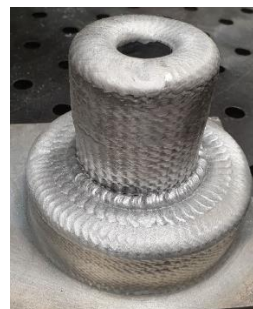
Рис. 14. Выращенный фланец: а — выращивание большого цилиндра; b — выращивание малого цилиндра.
