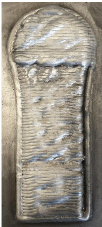
Рис. 11. Дефекты при выращивании кронштейна.
