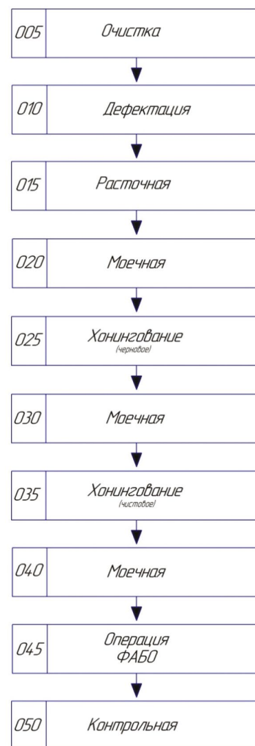
Рис. 1. Технологический процесс ремонта гильз цилиндров двигателя
